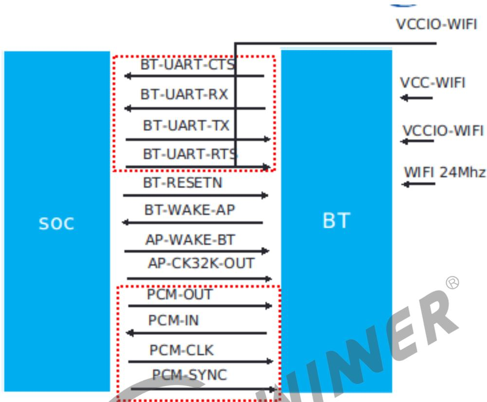
图 3-2: 主控与 bt 硬件连接简图
